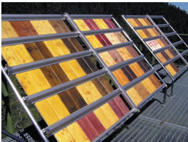
Наилучшей защиты позволяют добиться высокопигментированные лакокрасочные материалы, так как пигменты обеспечивают максимально эффективное отражение ультрафиолетового излучения. Бесцветные системы с ультрафиолетовой защитой способны обеспечить достаточную защиту лишь на короткий срок и требуют обслуживания через относительно небольшие промежутки времени (приблизительно каждые два года).
