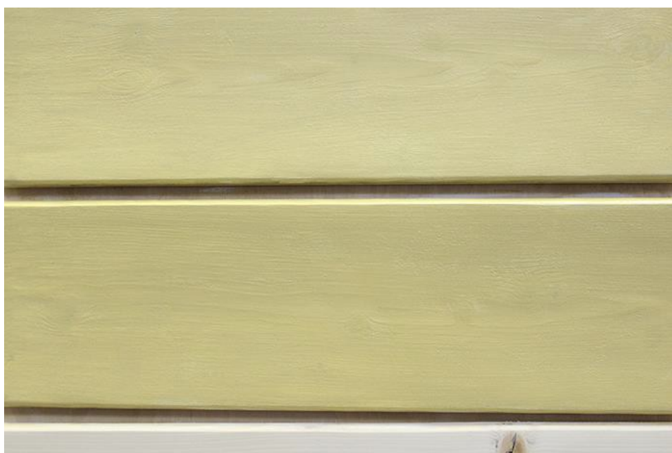
Готовое покрытие Pullex Color (2-х слойное нанесение)
