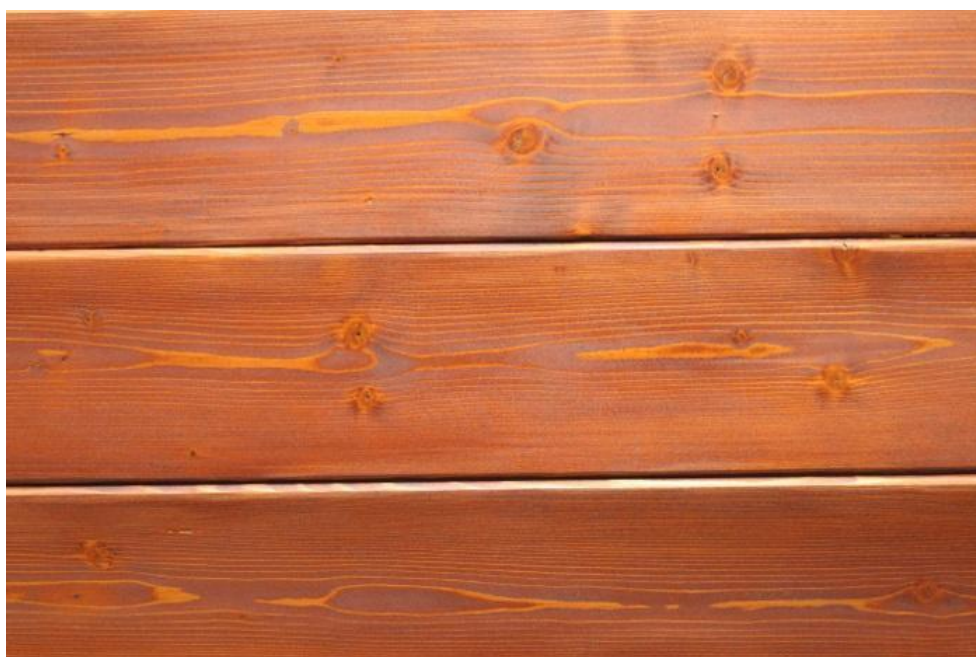
Готовое покрытие Pullex High-Tech (2-х слойное нанесение)
