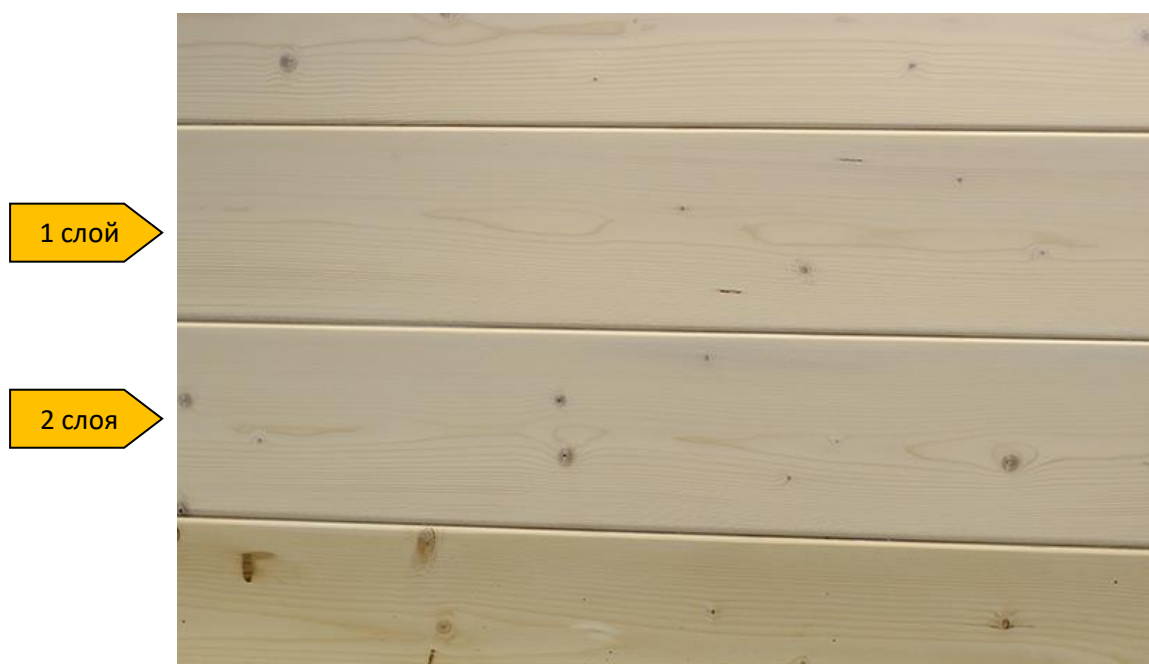
образцы с однослойным и двухслойным нанесением Lignovit Terra
